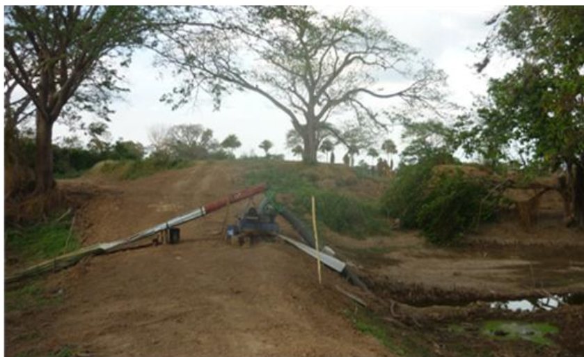
Figura 2-48. Sistema de bombeo de agua desde el río Cesar a una plantación.
