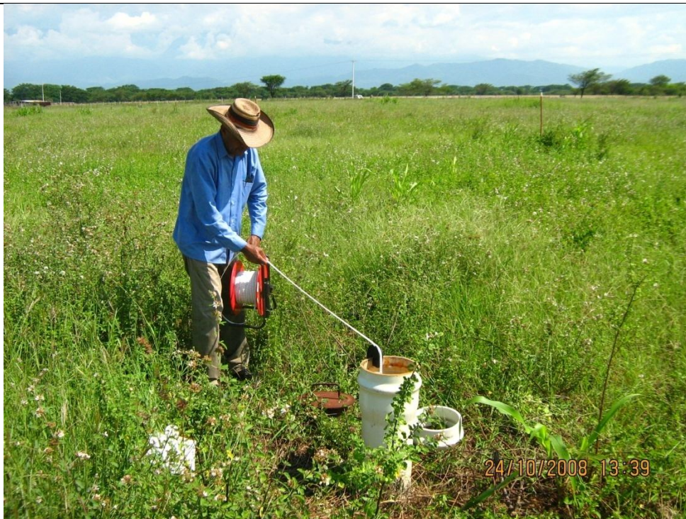
Foto 6. Medición en un pozo de observación
