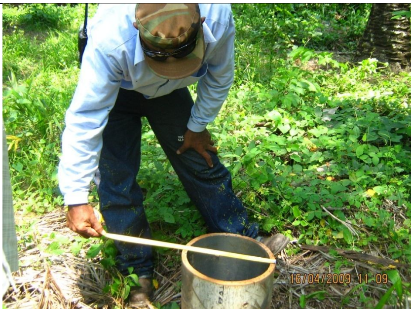
Foto 9. Medición del diámetro del tubo instalado en un pozo profundo
