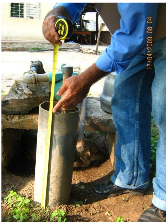
Fotos 2, 2A. Medición de la altura ( h ) de la boca del pozo sobre la superficie del terreno
