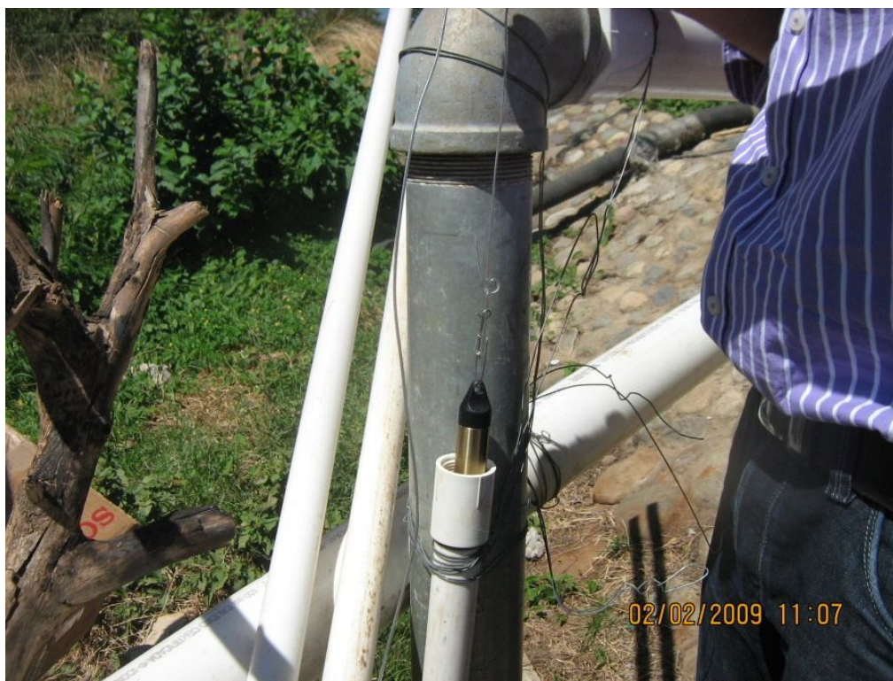
Foto 11. Introducción del sensor automático dentro de un tubo de \frac{3}{4} de pulgada de diámetro interno
