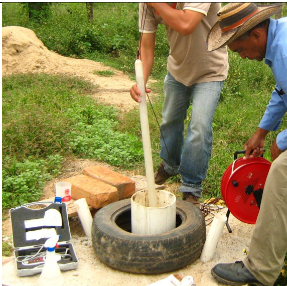
Foto 15. Extracción de agua con el uso de bailer
