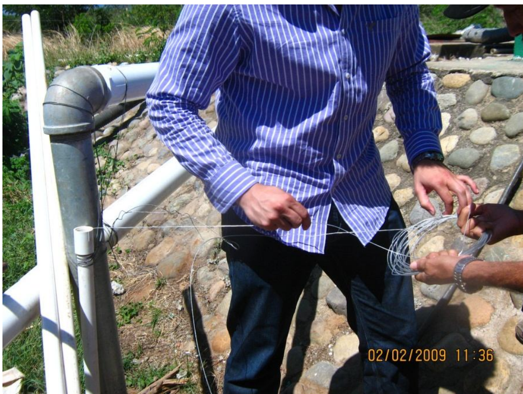
Foto 12. Descenso del sensor con un cable de acero hasta la profundidad deseada para el monitoreo
