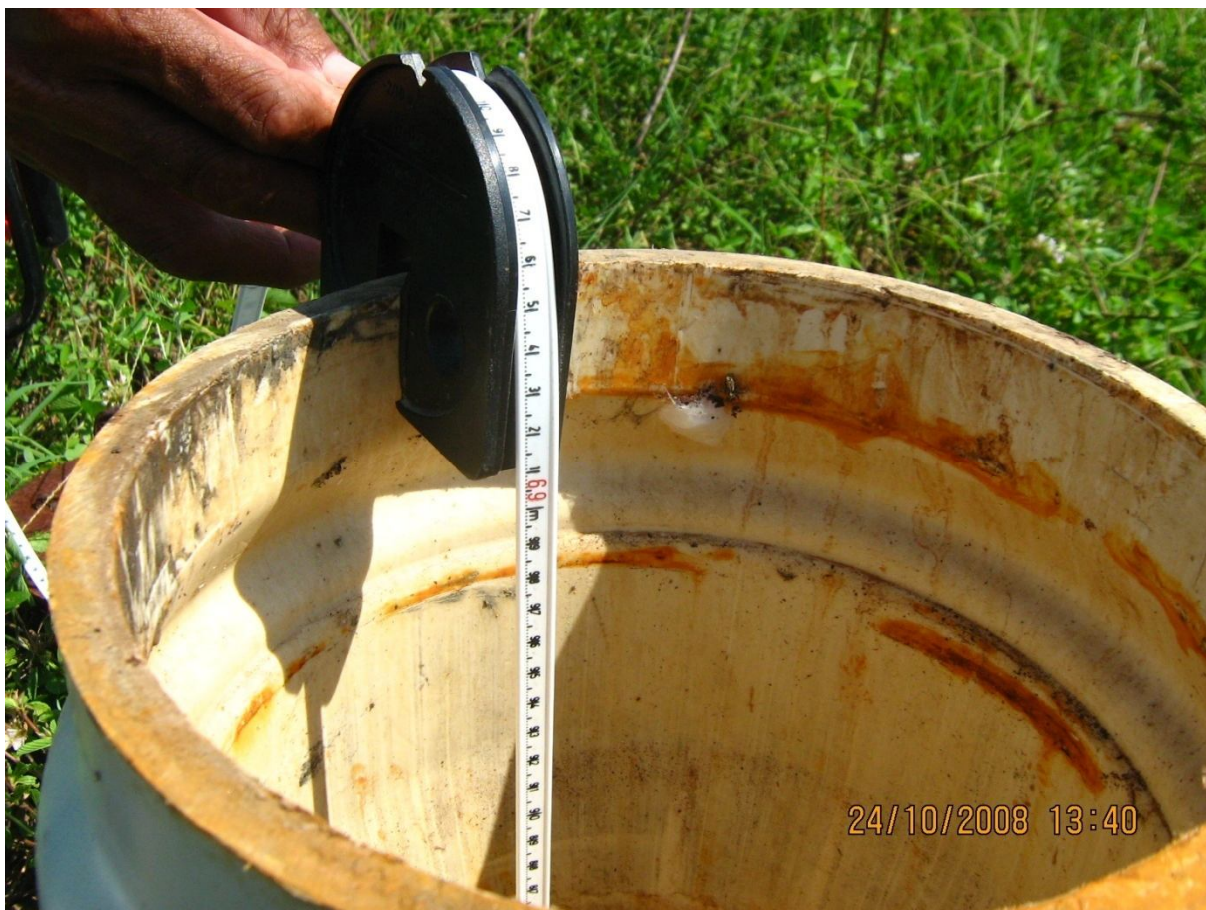
Foto 7. Medición en un pozo de observación, con ayuda de la guía para introducir la sonda. En la foto, se aprecia que se alcanzó un nivel de agua (o si es el caso, profundidad de pozo) de 69.05 mt.
