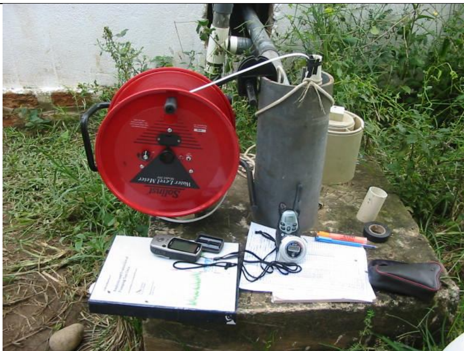
Foto 4. Medición de niveles usando tubería de \frac{3}{4} de pulgada en el interior de un pozo profundo
