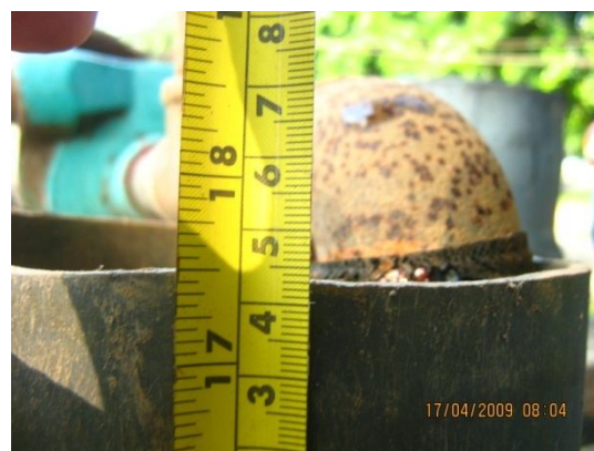
Fotos 2, 2A. Medición de la altura ( h ) de la boca del pozo sobre la superficie del terreno
