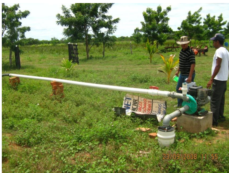
Foto 15. Conducción del agua bombeada hacia un punto localizado lejos del pozo.
