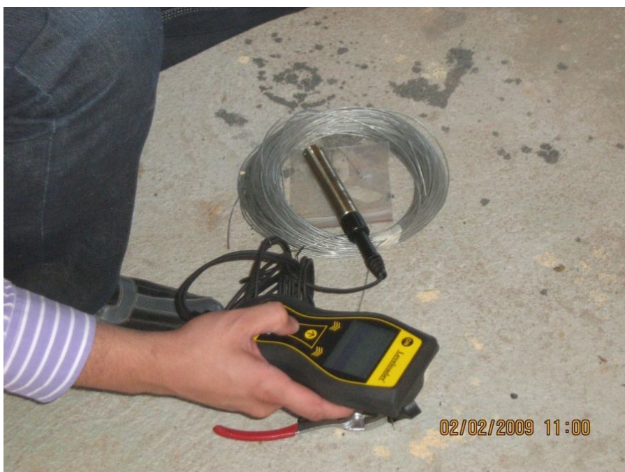
Foto 10. Programación del sensor automático
