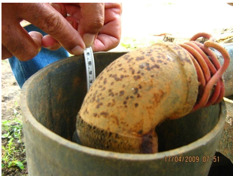
Foto 8. Lectura del nivel estático (o dinámico) de un pozo profundo
