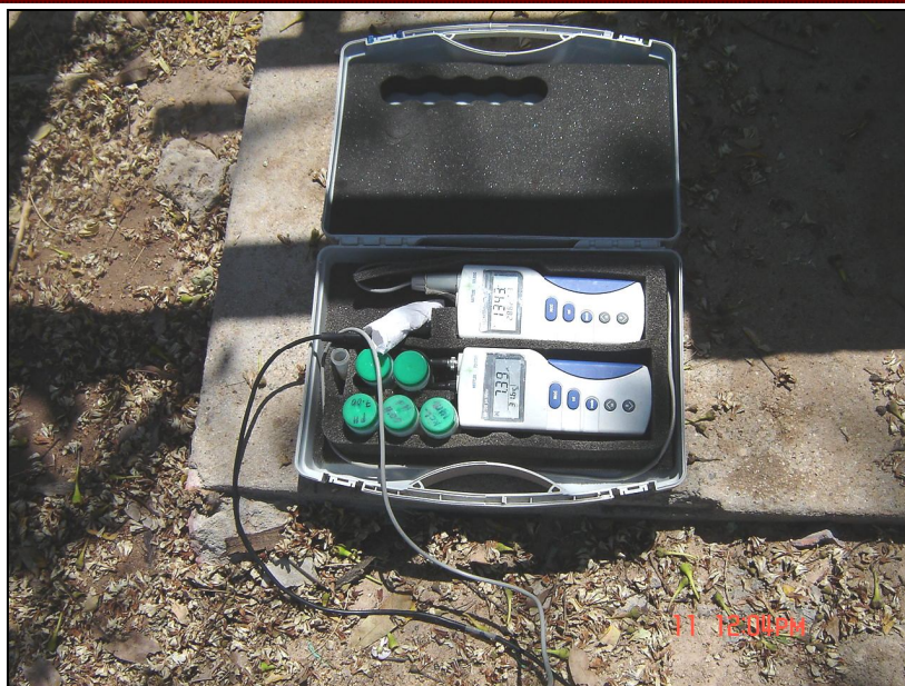
Foto 16. Equipo de medición de propiedades físicas del agua en campo, pHmetro y Conductivímetro.
