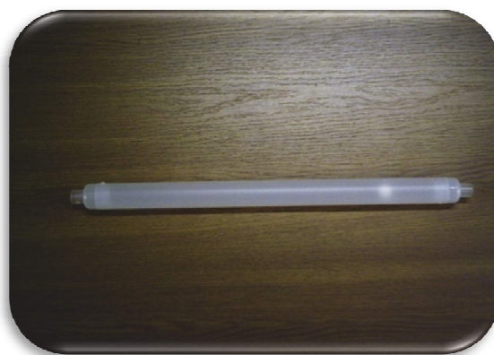
Fig. 2 Bailer: instrumento para toma de muestra en pozos
