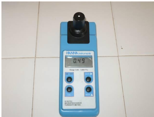
Figura 21. Turbidímetro utilizado para los análisis de turbiedad (HANNA INSTRUMENTS)
