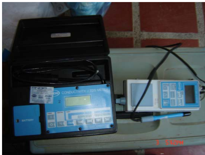
Foto 62 Equipo Portátil de Monitoreo HORIBA medidor de Ph, Conductividad, Turbiedad, D.O, Temperatura y Salinidad del agua.
