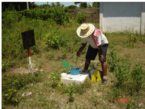
Foto 99. Monitoreo de niveles con sondas convencionales en el piezómetro de Astrea
