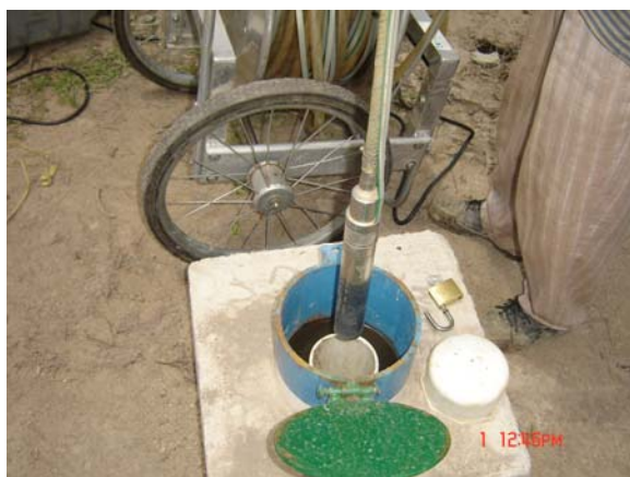
Foto 100. Muestreo de las aguas del piezómetro de Astrea con una bomba peristáltica.
