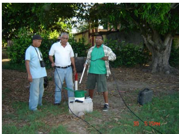
Foto 102. Calibración de una sonda de presión para registrar los niveles estáticos en el piezómetro de Becerril
