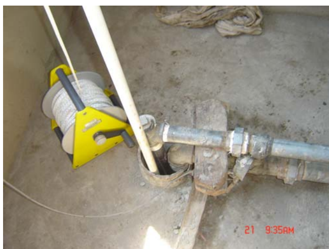
Foto 29. Medición del nivel estático con sonda convencional en un aljibe.
