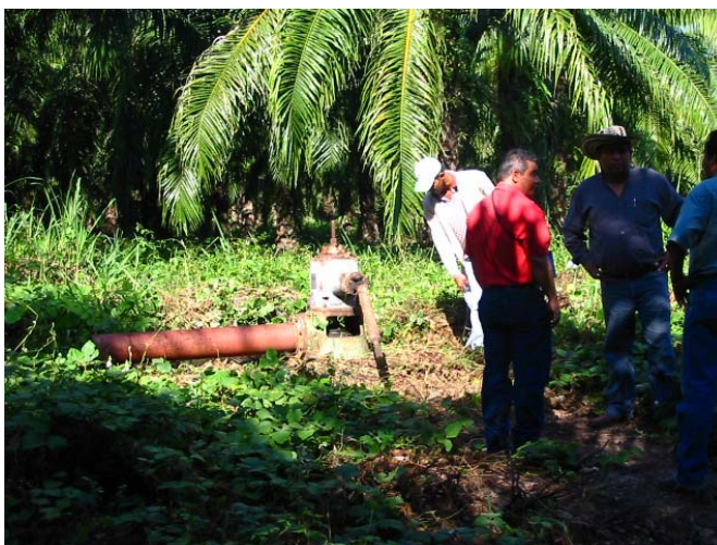
Foto 33 Pozo profundo con bomba sumergible de eje vertical que abastece los cultivos de Palmas Montecarmelo (Agustín Codazzi)
