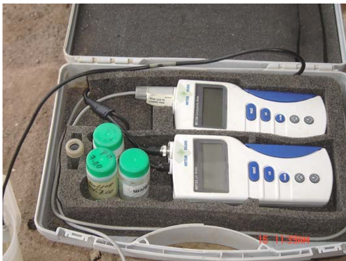
Foto 63. Equipo Mettler Toledo para medir la Conductividad, los Sólidos Disueltos Totales (S.D.T.) y el Ph.
