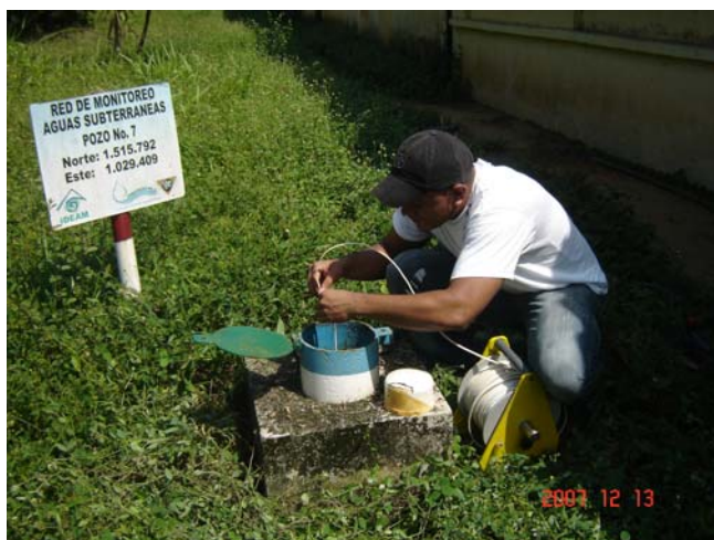
Foto 105. Monitoreo de niveles con sondas convencionales en el piezómetro de Chimichagua.
