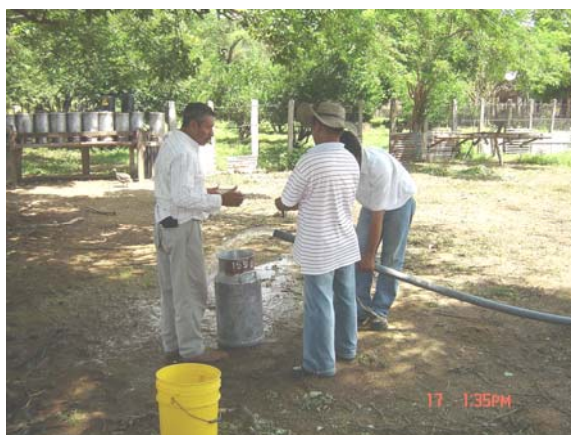
Foto 28. Aforo volumétrico de aljibes y pozos, durante la ejecución de pruebas de bombeo
