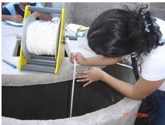
Foto 29. Medición del nivel estático con sonda convencional en un aljibe.
