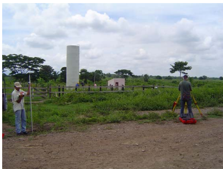
Foto 60. Nivelación de un aljibe típico en el área de estudio.
