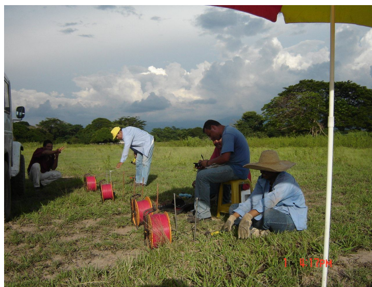
Foto 60. Disposición de electrodos de potencial y resistividad.
