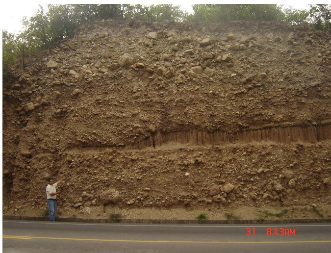
Foto 37. Capas gruesas de gravas del ápice del Cono Aluvial de Aguachica (Qcal 3 )
