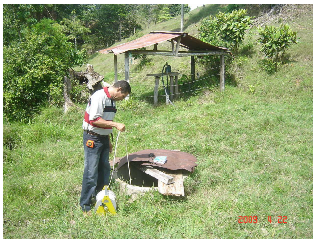
Foto 57. Medición del nivel estático de un aljibe con sonda convencional.
